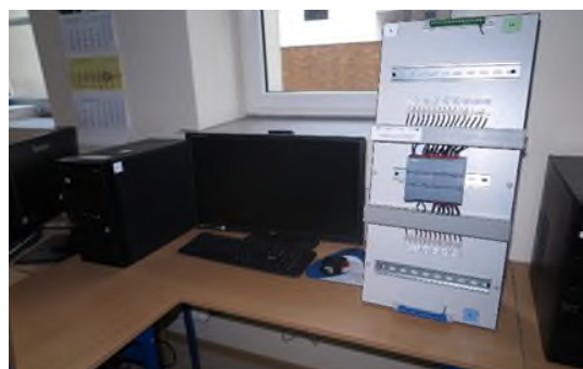
Rysunek 55 Zestaw komputerowy wraz z stanowiskiem dydaktycznym wykonanym z wykorzystaniem sterowników PLC
