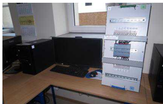
Zestaw komputerowy wraz z stanowiskiem dydaktycznym wykonanym z wykorzystaniem sterowników PLC
